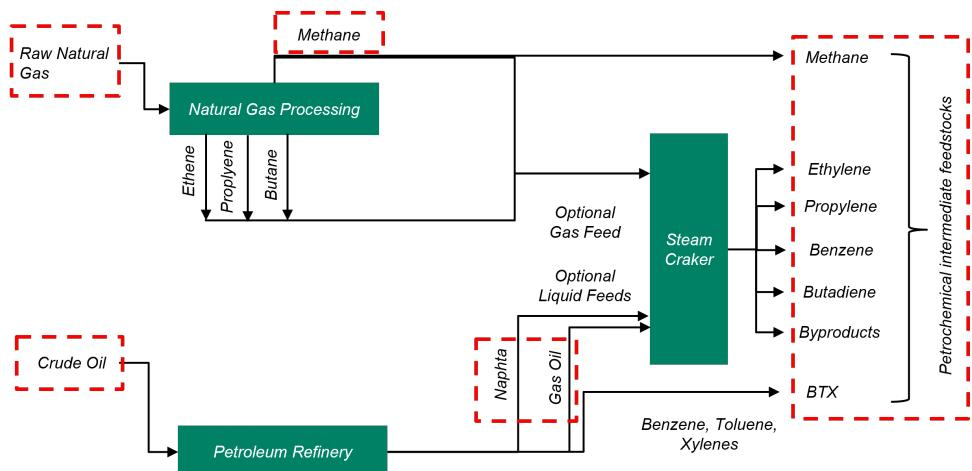
Gambar di atas menunjukkan contoh dari *feedstock* yang biasa digunakan dalam proses pembuatan bahan kimia. *Feedstock* ditandai dengan kotak merah seperti dalam gambar. *Feedstock* terdiri dari 2 jenis, yakni (a) *basic feedstock* seperti *crude oil*, *raw natural gas*,
